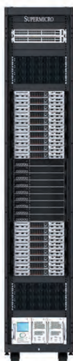
Рис. 1. Компонування стійки GB300 NVL72 на прикладі реалізації Supermicro
