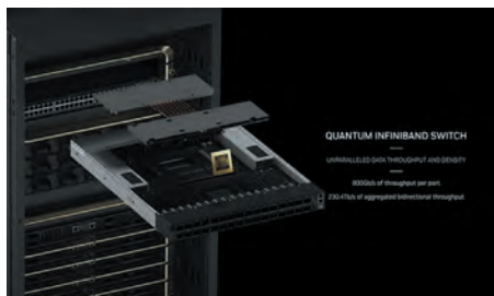
Рис. 5. Мережевий комутатор Quantum InfiniBand у компонуванні 1U
