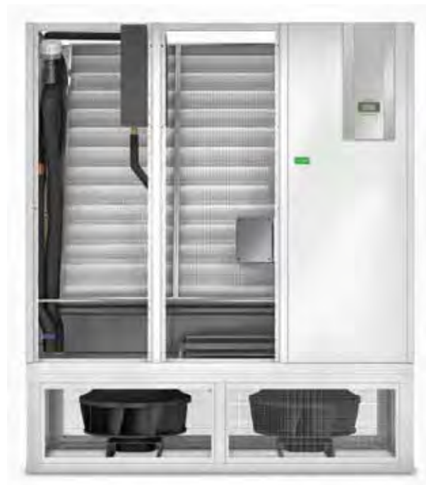
Рис. 3. Прецизионные водяные кондиционеры Uniflair LE HDCV позволяют располагать вентиляторы под фальшполом
