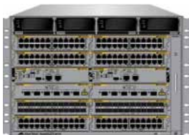
Рис. 3. Шассийные коммутаторы Allied Telesis SwitchBlade x8112 могут выступать в роли SDN-контроллеров
