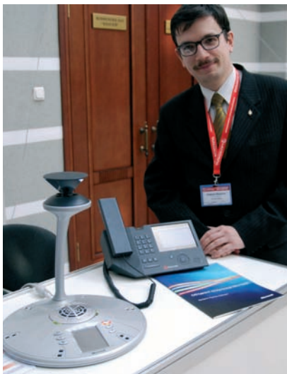
Рис. 17. Аппаратный модуль системы видеоконференц-связи Roundtable, рядом IP-телефон Polysom, интегрируемый с продуктами Microsoft UC
