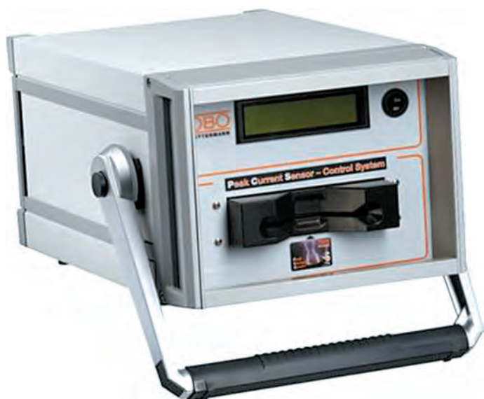
Рис. 5. Зчитувач записів імпульсних струмів з давачів PCS-card
