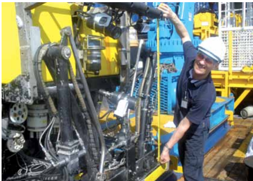
Далекая Малайзия, Малаккский пролив: автор статьи отлаживает автоматического робота, предназначенного для нахождения поврежденных подводных газопроводов
