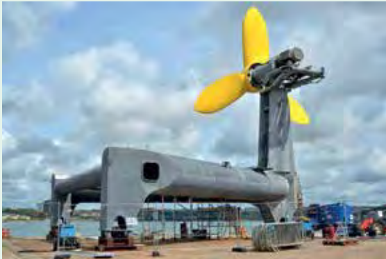
Подводный электрический генератор DeltaStream мощностью 400 кВт
