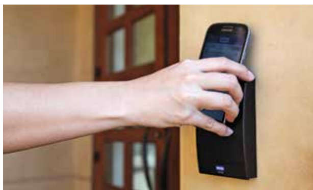
Рис. 3. В качестве ключа в современных СКД может использоваться обычный смартфон
