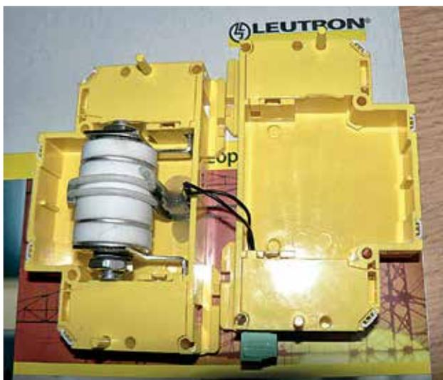
**Рис. 13.** Внутреннее устройство УЗИП типа 1 компании Leutron
