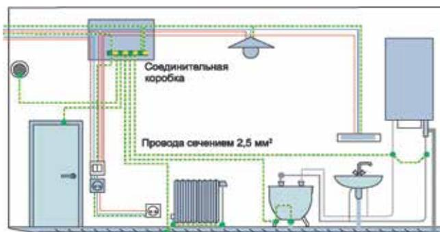
Рис. 23. Схема использования шины уравнивания потенциалов в жилом доме
