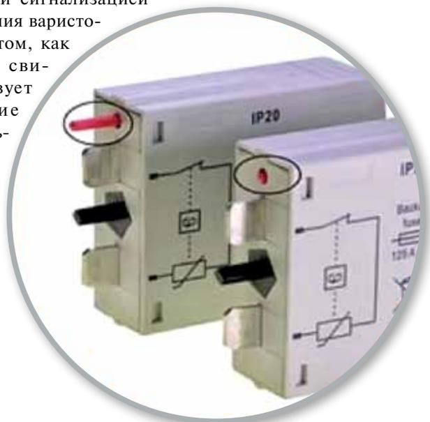
**Рис. 4.** Положение выдвижного штока позволяет идентифицировать рабочее или неисправное состояние сменного модуля УЗИП (иллюстрация взята из каталога ETI)
