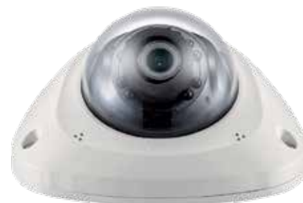
Рис. 10. Новая FullHD-камера Hanwha Techwin SNV-L6014RM для установки в общественном транспорте
