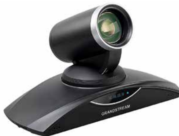
Рис. 10. Терминал Grandstream GVC3200 со встроенным сервером ВКС и поддержкой до девяти одновременных участников конференции
