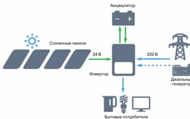
Рис. 3. Гибридная система электроснабжения
