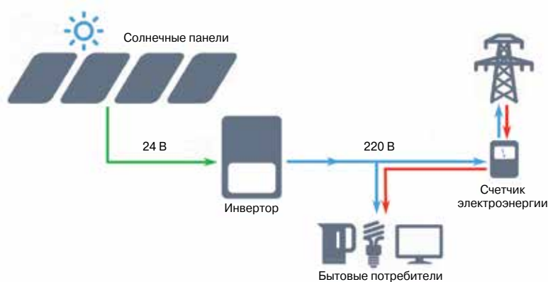
Рис. 2. Солнечная электростанция с подключением к сети
