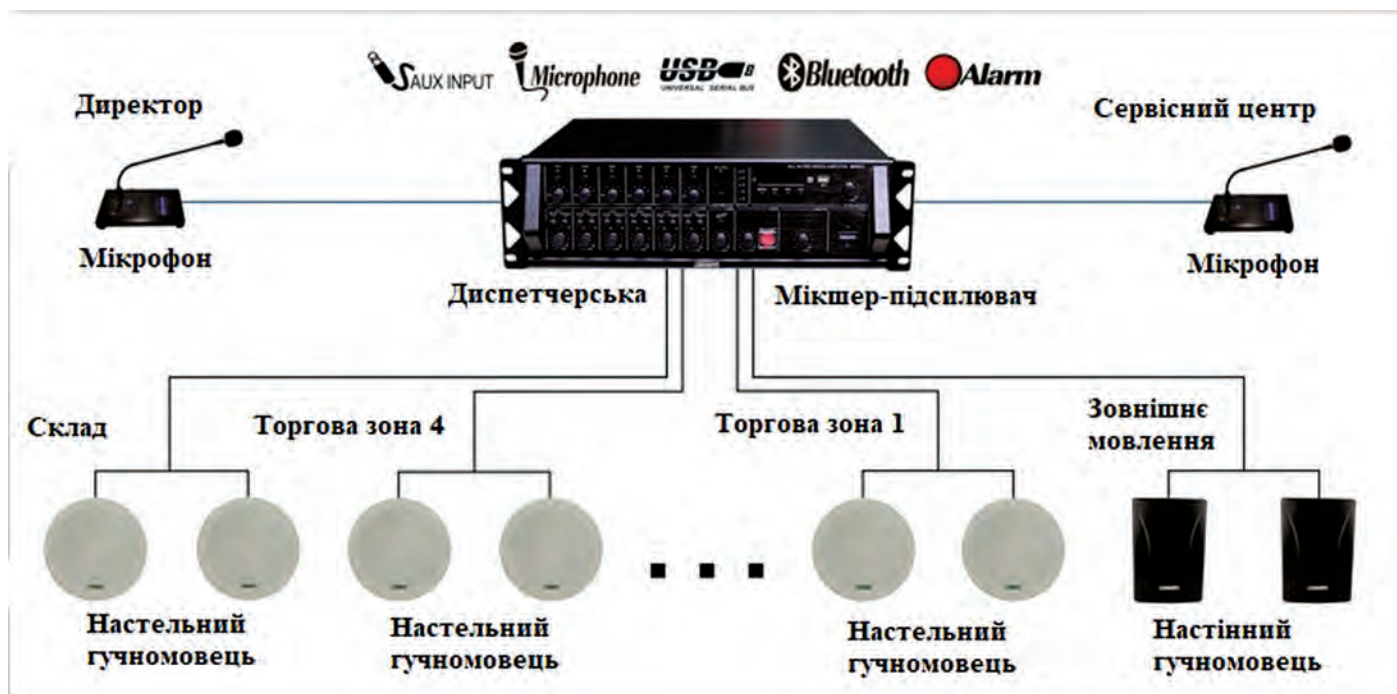
Рис. 1. Шестизонна система гучномовного оповіщення у торговельному центрі на прикладі китайського рішення DSSPA MP812
