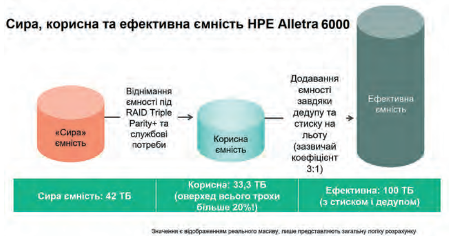
Рис. 2. Ефективна ємність HPE Alletra 6000 може бути втричі більшою за номінальну корисну
