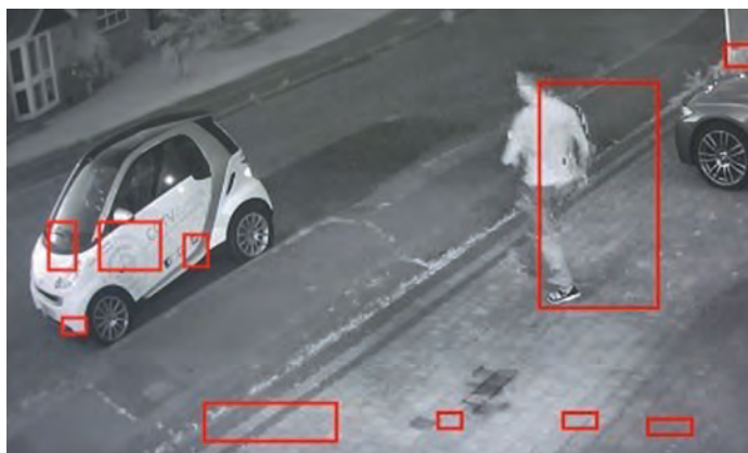
Рис. 6. Традиційна IVA-аналітика визначила багато зон, де нібито є рух, хоча рухається в кадрі лише людина
