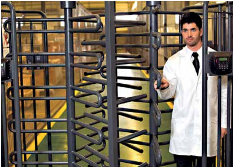
Рис. 3. Полноростовый роторный турникет, совмещенный с СКД
