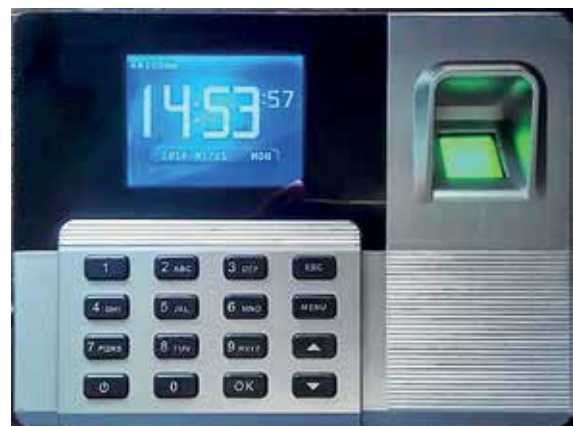
Рис. 5. Считыватель системы многофакторной аутентификации
