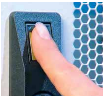
Рис. 10. Серверная стойка, оснащенная электронным замком и дактилоскопическим сканером
