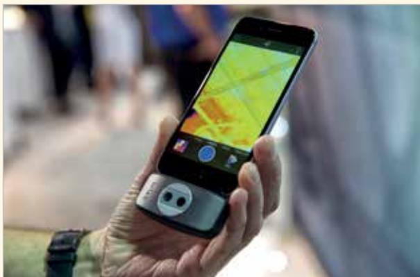
Мини-тепловизор FLIR One, подключенный к смартфону
