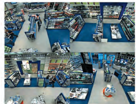
Рис. 7. Технологія Dewarping (360° панорама — ліворуч, вид у «квадраті» — праворуч)
