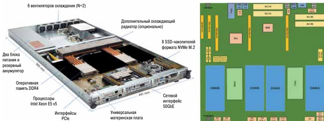
**Рис. 7.** Перспективный сервер Olympus для облачных дата-центров Microsoft: внешний вид и схема расположения основных элементов
