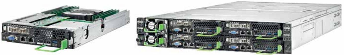
**Рис. 9.** Высокопроизводительный сервер Fujitsu Primergy CX1640 M1 на базе процессора Intel Xeon Phi — отдельно (на фото слева) и в составе платформы CX600 M1
