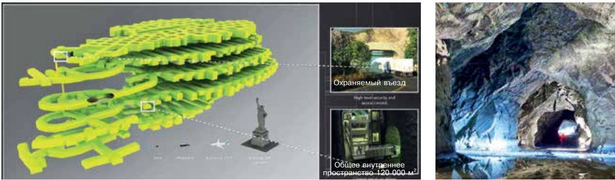
Рис. 3. Дата-центр Lefdal Mine — трехмерная визуализация плана помещений. (на схеме для сравнения — статуя Свободы, высота которой 91 м); справа — фотография одной из штолен
