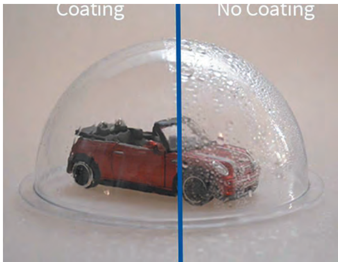
Рис. 16. Наочна демонстрація водовідштовхувального ефекту покриття Mobotix EverClear (ліворуч) у порівнянні з незахищеним пластиком
