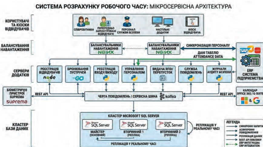
Рис. 3. Мікросервісна архітектура, реалізована на Java Spring Boot та Angular
