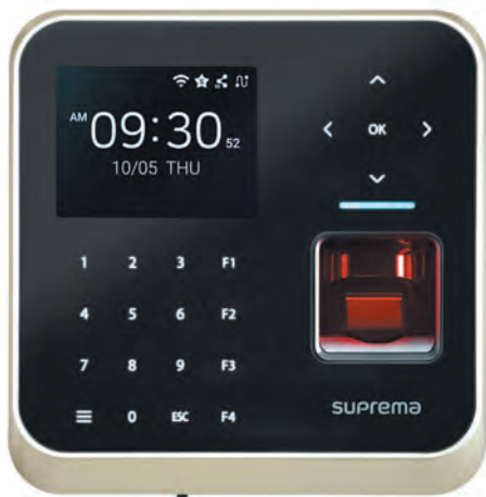
Рис. 2. Suprema BioStation 2a забезпечує надзвичайну точність та швидкість розпізнавання відбитків
