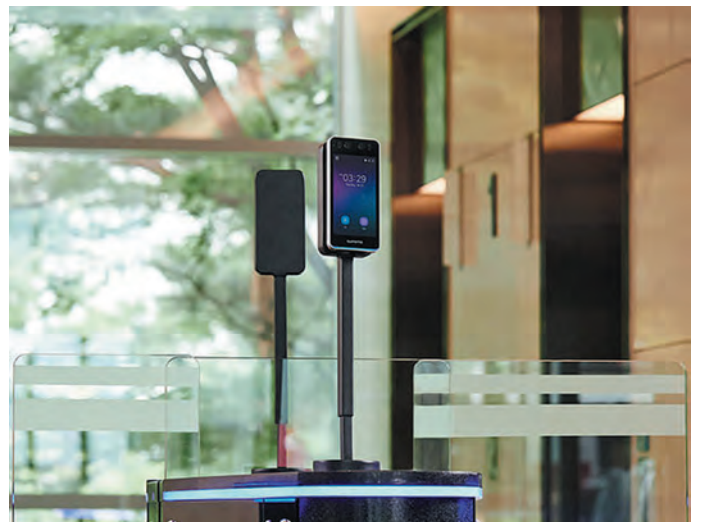
Рис. 3. Біометричний термінал з розпізнаванням облич та зчитуванням RFID-карток
