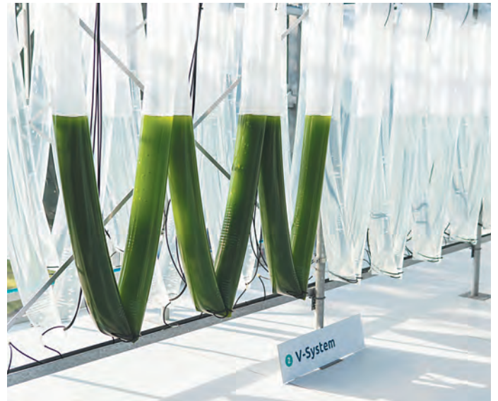
Рис. 4. Теплица, расположенная на крыше дата-центра Windcloud, обогревается теплом ИТ-оборудования. А выращивают в ней специальные водоросли
