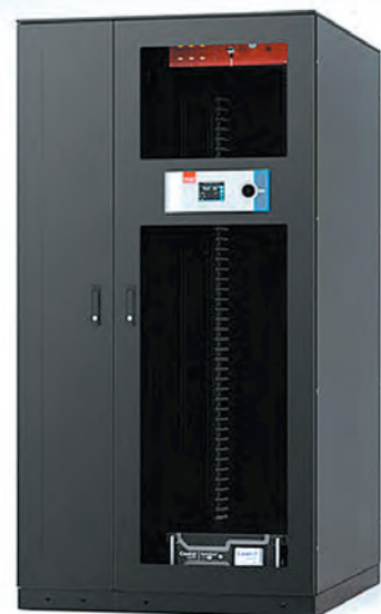
Рис. 12. Микро-ЦОД Stulz с прямым жидкостным охлаждением Direct Contact Liquid Cooling позволяет отводить до 80 кВт тепла от одной стойки с ИТ-оборудованием
