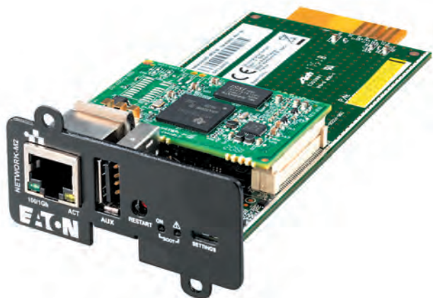
Рис. 10. Защищенная гигабитная сетевая карта для ИБП Eaton
