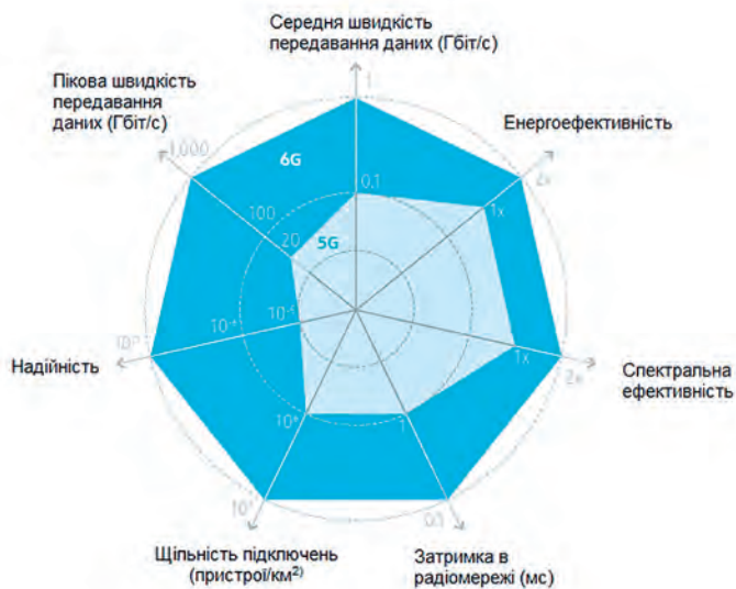
Рис. 1. Порівняння основних показників роботи мереж 5G і 6G (джерело: Samsung)
