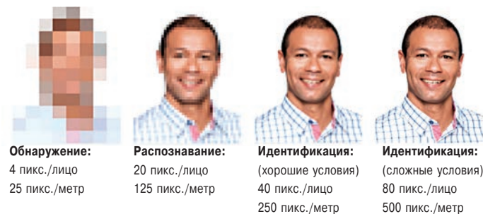
Рис. 1. Минимальные требования для обнаружения, распознавания, идентификации человека системой видеонаблюдения
