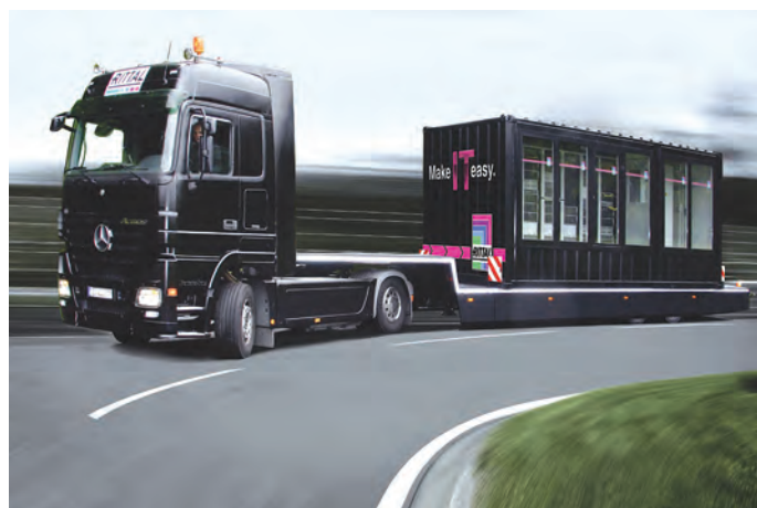
Рис. 3. Доставка контейнерного ЦОД Rittal на специальной платформе к месту эксплуатации
