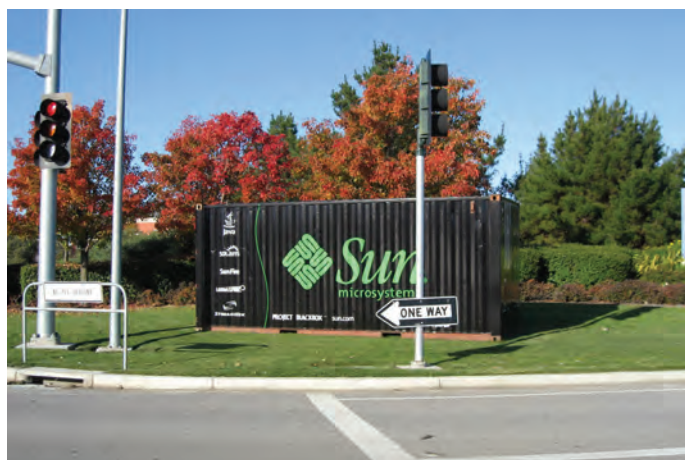
Рис. 2. Первая серийная модель КЦОД — Sun Microsystems BlackBox. Контейнер установлен под открытым небом
