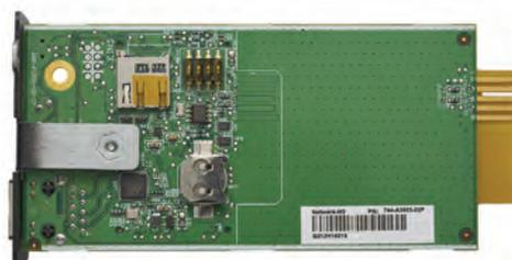
Рис. 8. Защищенная сетевая карта для ИБП Eaton Gigabit Network M2
