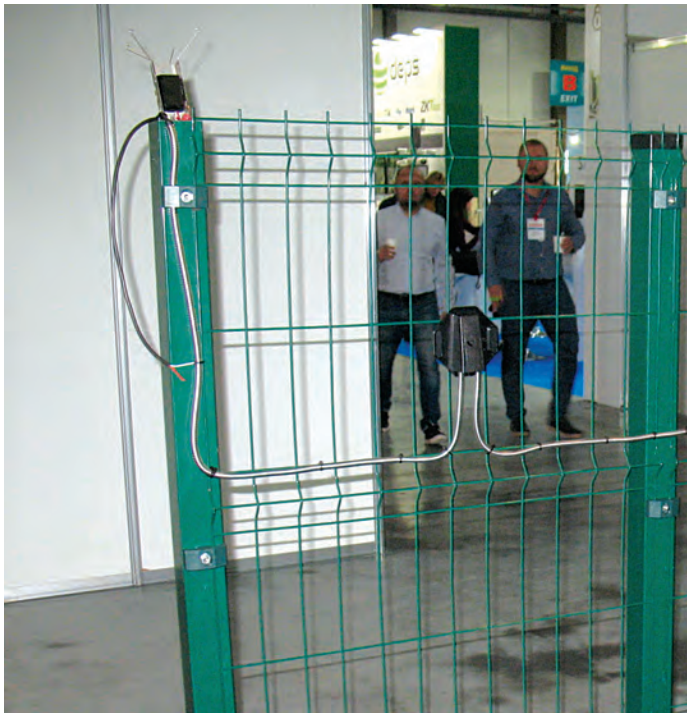
Рис. 2. Датчик Peridect для скрытой установки (стенд «Центурион» на выставке «Безпека-2019»)
