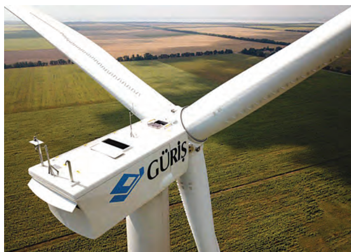
Ветрогенератор GE 3.6-131 единичной мощностью 3,6 МВт ВЭС «Овод Винд 1» компании «Гюриш Иншаат ве Мюхендислик А.Ш.»
