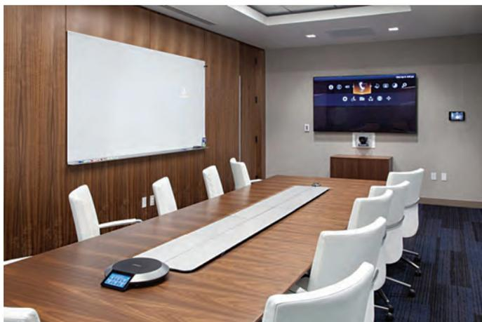
**Рис. 1.** Пример оформления переговорной комнаты для ВКС: мебель в приглушенных цветовых тонах, на стенах звукопоглощающие панели, на полу — ковролин
