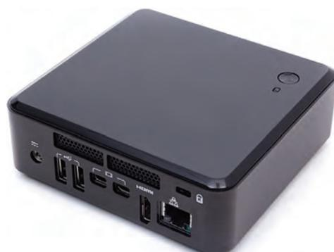
**Рис. 8.** Мини-ПК Intel NUC может использоваться в качестве кодека ВКС при условии установки на него специализированного ПО
