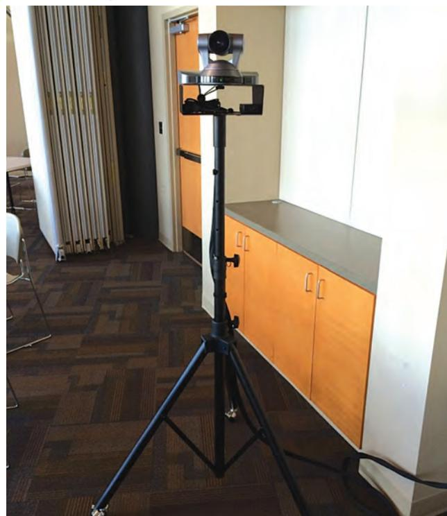
**Рис. 2.** PTZ-камера, установленная на мобильном штативе примерно на уровне глаз стоящего человека
