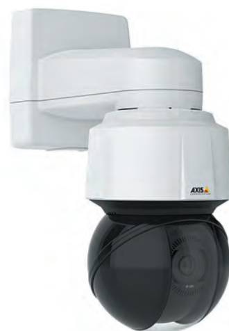
Рис. 1. Новая уличная PTZ-камера Axis Q6135-LE с 32-кратным оптическим увеличением
