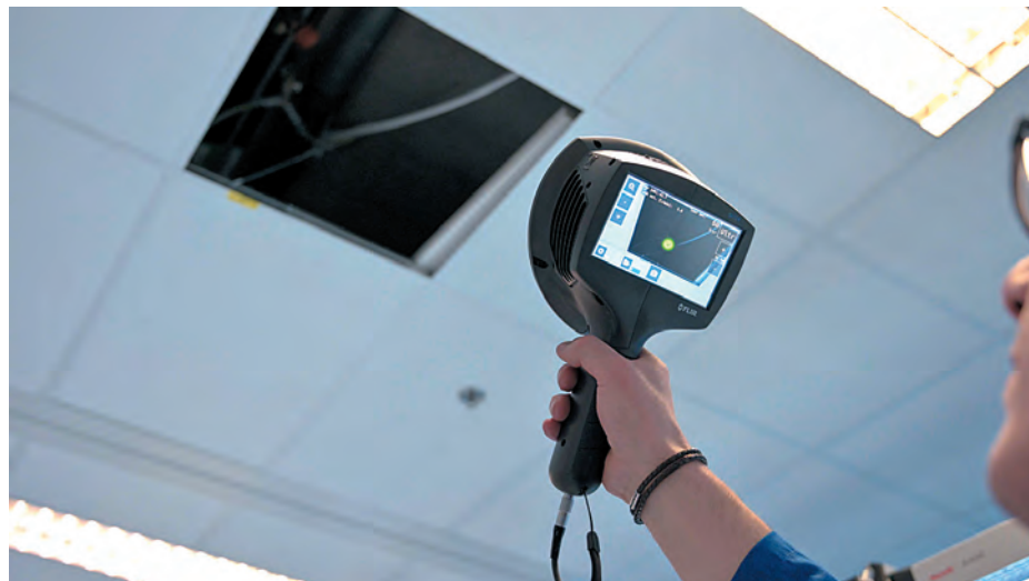
Рис. 10. Ультразвуковая камера FLIR Si124 помогает обнаружить утечки газов или наличие частичных разрядов (коронация, искрение) даже в сильно зашумленной промышленной среде
