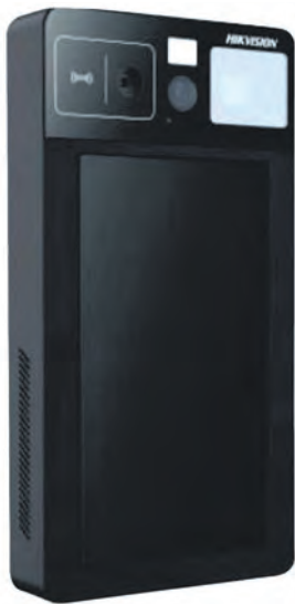
Рис. 14. Терминал термометрического контроля Hikvision DS-MDH005-B для бесконтактного измерения температуры тела пассажиров общественного транспорта
