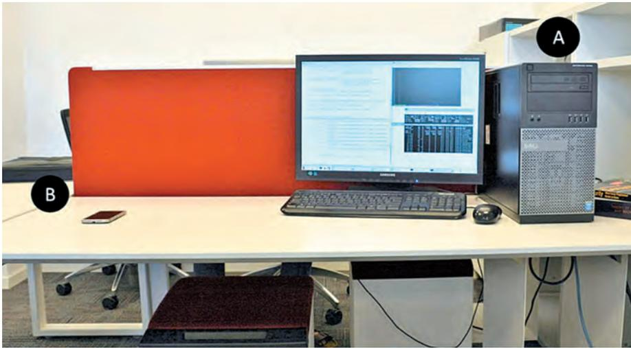
**Рис. 3.** Fansmitter: зараженный компьютер без динамиков и с отключенными аудиовыходами (A) передает данные на мобильный телефон (B) посредством акустических сигналов (рисунок из статьи Мордехая Гури и др.)
