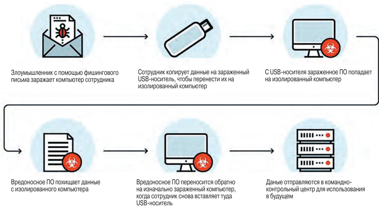
Рис. 1. Взлом изолированного компьютера с помощью USB-носителя (источник: Trend Micro)
