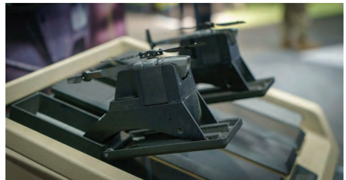
Рис. 2. Армейский микродрон FLIR Black Hornet 3 в одиночной версии и на платформе для группового запуска
