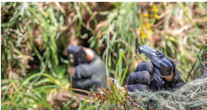
Рис. 2. Армейский микродрон FLIR Black Hornet 3 в одиночной версии и на платформе для группового запуска
