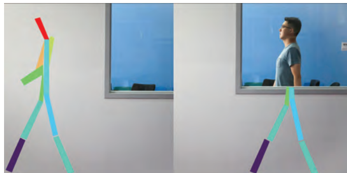
Рис. 1. Система RF-Pose «видит» человека за стеной
