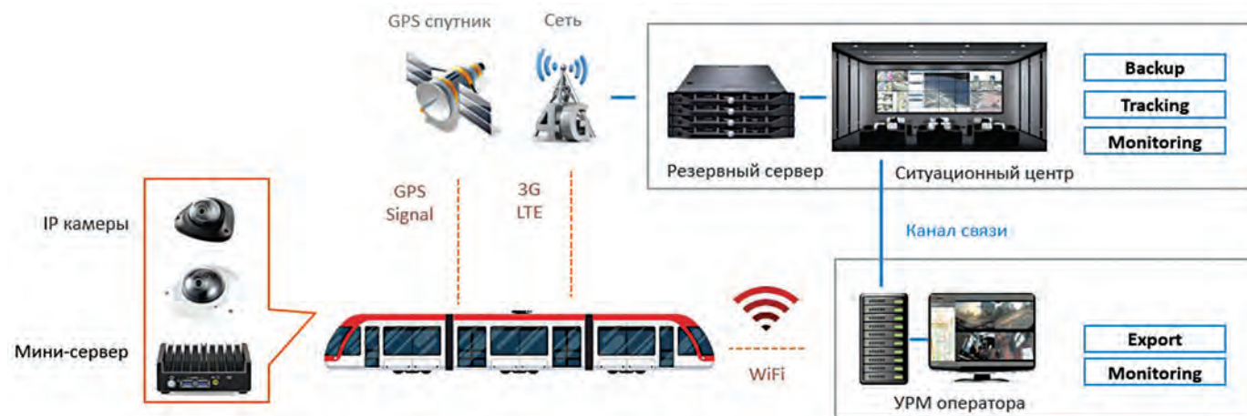
Рис. 3. Схема централизованной системы IP-видеонаблюдения для транспорта
