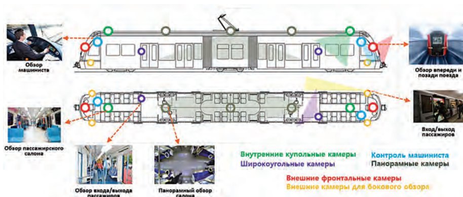
Рис. 2. Пример установки камер СВН и зон визуального контроля в метро/электричках/поездах
