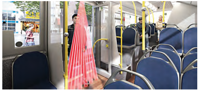
Рис. 4. Визуализация процесса подсчета пассажиров в автобусе с помощью датчика подсчета/модуля видеоаналитики
