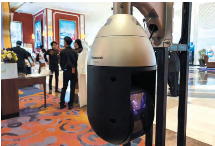
Рис. 12. Камера Panasonic i-PRO WV-X6533LN с 40-кратным оптическим приближением, оснащенная ИК-подсветкой на 350 метров
