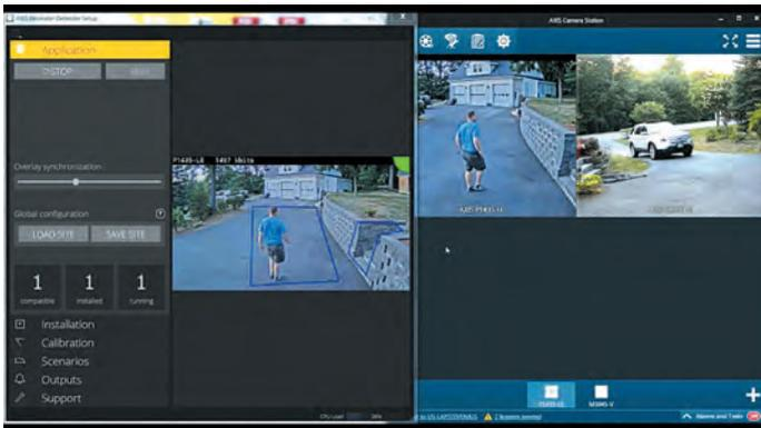
Рис. 6. Решение для охраны периметра Axis Perimeter Defender: вид одного из окон интерфейса
