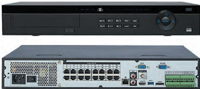
Видеорегистратор типа NVR, оснащенный шестнадцатью Ethernet-портами с поддержкой PoE: вид с фронтальной и тыльной сторон
