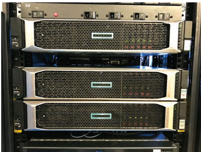
Рис. 6. Гиперконвергентный кластер HPE SimpliVity на базе серверов ProLiant DL 380 Gen10
