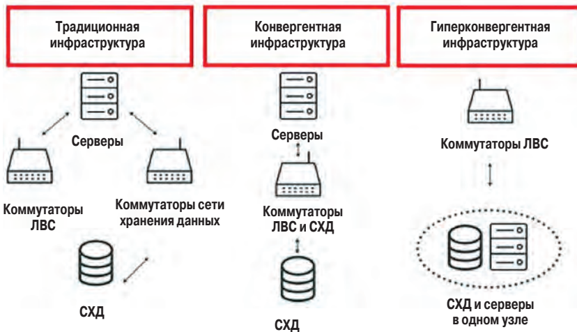
Рис. 1. Схематическое сравнение трех подходов к построению ИТ-инфраструктур: традиционного, конвергентного и гиперконвергентного
