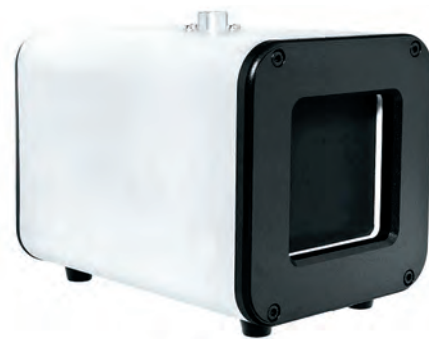
Рис. 6. Калибратор для тепловизора — модель абсолютно черного тела позволяет снизить погрешность при измерении температуры тела до 0,3 °C
