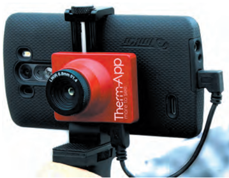
Рис. 11. Миниатюрная камера Orgal ThermApp, превращающая смартфон в компактный тепловизор
