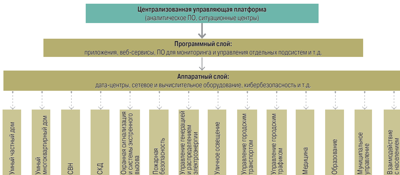
Рис. 3. Концептуальная схема технической реализации системы Smart City
