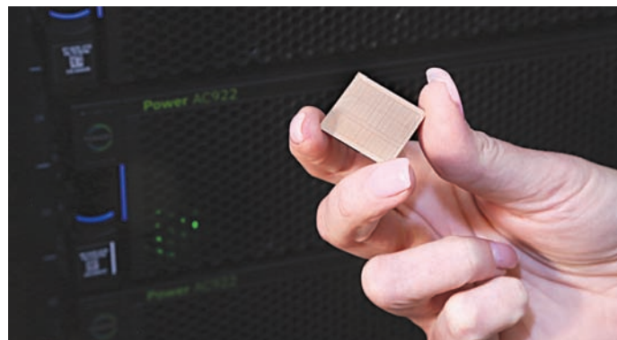
RISC-процессор IBM POWER9. На фоне видны серверы IBM Power AC922, в которых используется этот новый чип
