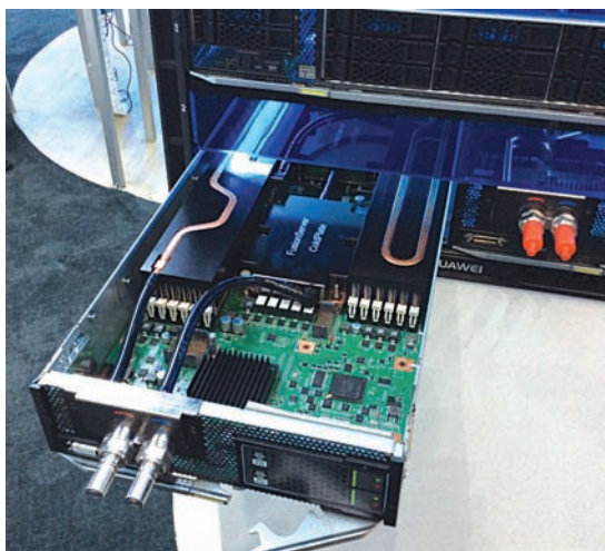
Блейд-платформа Huawei FusionServer E9000, оснащенная системой жидкостного охлаждения
