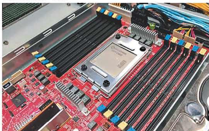
48-ядерный ARM-процессор Qualcomm Centriq 2400 в составе сервера под управлением ОС Windows Server. Система создана в рамках инициативы Open Compute Project
