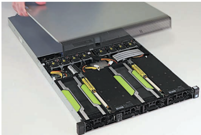
Сервер Dell EMC PowerEdge C4140 для высокопроизводительных вычислений оснащен процессорами Intel Xeon Scalable и графическими ускорителями Nvidia Tesla
