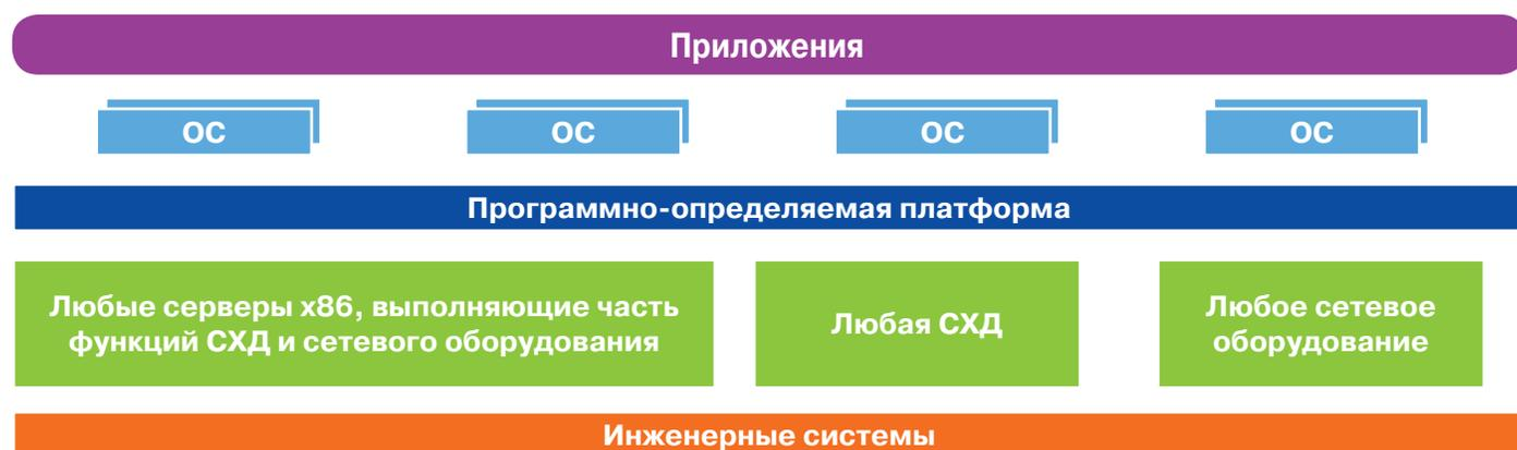
Логическая схема программно-определяемого дата-центра (SDDC)
