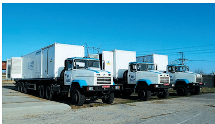
Рис. 8. Генераторы Cummins в контейнерах на грузовиках КрАЗ, поставленные на одну из АЭС (проект «Далгакиран компрессор Украина»)
