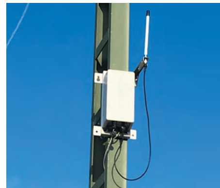
Рис. IoT-шлюз TEKTELIC KONA Macro в уличном варианте установки
