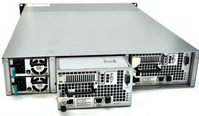
Рис. 25. Корпус отказоустойчивой СХД Synology UC3200 содержит два контроллера, работающих в режиме «активный-активный»
