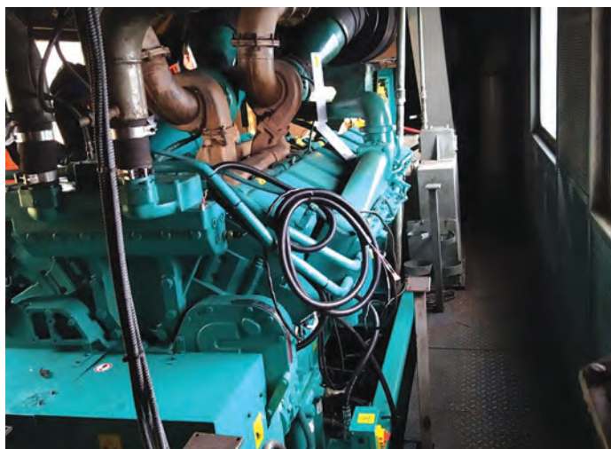
Рис. 6. Дизель-генератор Cummins, приводящий в движение рельсошлифовочный поезд
