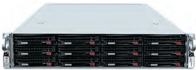
Рис. 2. Пример аппаратной реализации «песочницы»: FortiSandbox FSA-3000E
